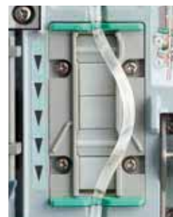
例えば誤装着でチューブが浮いたり曲がったりしていると...
